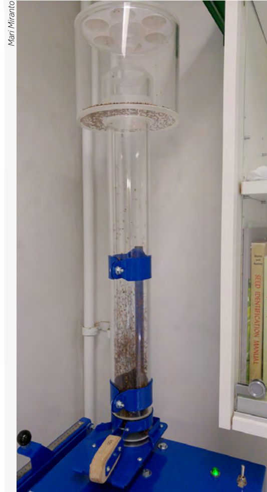
Aspiraattori erottelee tyhjät ja kunnolliset siemenet toisistaan.
